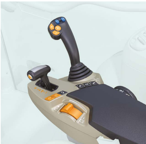
Kabinen-Variante Efficient mit elektrischem Multifunktions-Joystick und Armlehne
