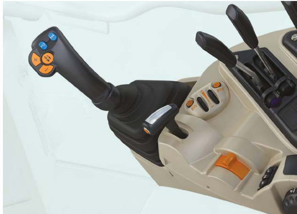
Kabinen-Variante Essential mit mechanischem Multifunktions-Joystick
