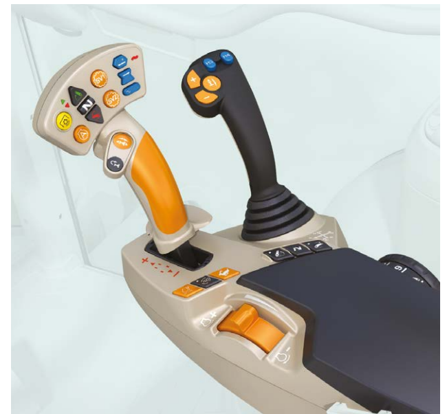
Kabinen-Variante Exclusive mit MultiPad-Hebel und elektrischem Multifunktions-Joystick (auf der rechten Seite)
