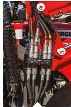
Basiskonfiguration mit flachen Einzelkupplungen
