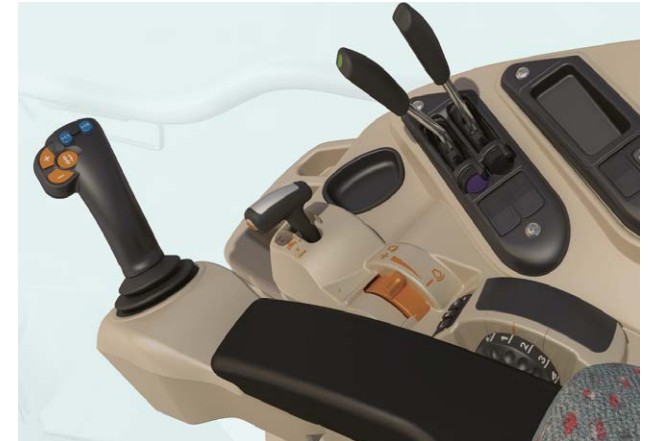
MF 5700 SL-Kabinen-Variante Essential mit elektrischem Frontlader-Multifunktions-Joystick
